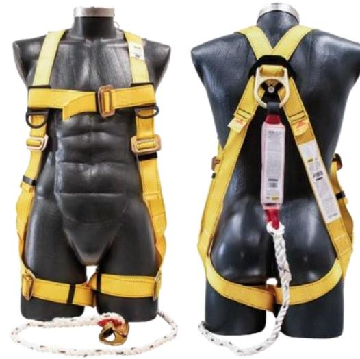
Arnés con anillo "D" en la espalda y amortiguador de impacto con cable de cuerda nailon de 1/2" de diámetro. Incluye como atributos del ARN-L y el C-ARN-L. Estos equipos deben ser conectados a estructuras que son capaces de resistir 2,268 kg.
