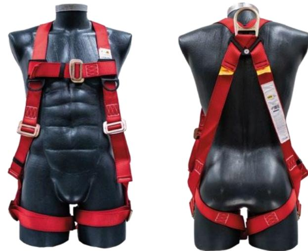
Al sufrir una caída el arnés de cuerpo distribuye la fuerza que se aplica en el cuerpo del trabajador en los codos, hombros, pecho y torso. Fabricado en banda de 1 3/4 de ancho. Anillo deslizante en la espalda. Correas de cintura y piernas ajustables. Hebillas de rápida conexión. Disponible con hebillas de machuelo y de seguridad QR.
